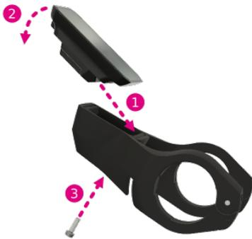
1. Display mit dem unteren Teil an die Halterung ansetzen.
