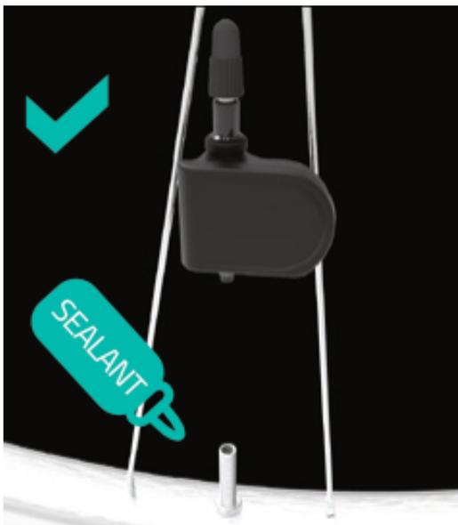
Die gesamte Sensoreinheit muss vom Ventilschaft entfernt werden und das Ventil muss abgeschraubt werden, bevor der Reifen durch den Ventilschaft mit schlauchlosem Dichtmittel gefüllt wird.
